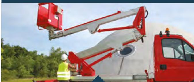
Nacelle fixe (avec stabilisateurs en position de travail), et à élévation multidirectionnelle.
