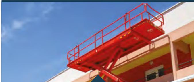
Nacelle fixe (avec stabilisateurs en position de travail), et à élévation verticale.
