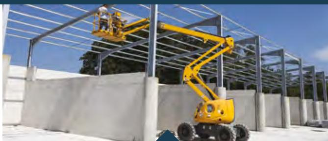
Nacelle mobile et à élévation multidirectionnelle.
